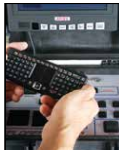
Teclado inalámbrico para la titulación de videos y anotación de fallas
